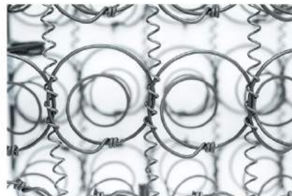
▲ 彈簧床墊構造複雜難回收處理 床墊裡頭除了鐵製彈簧網外，還有不織布、泡棉等等中間夾層的添加物
